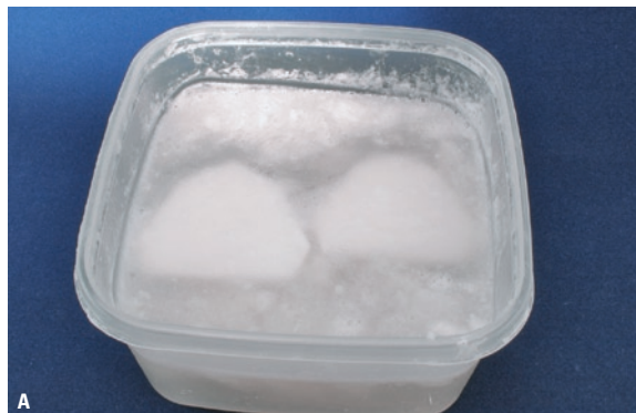
FIGURA 12 - A) Imersão dos modelos em solução de sabão. B) Polimento com tecido de seda.
